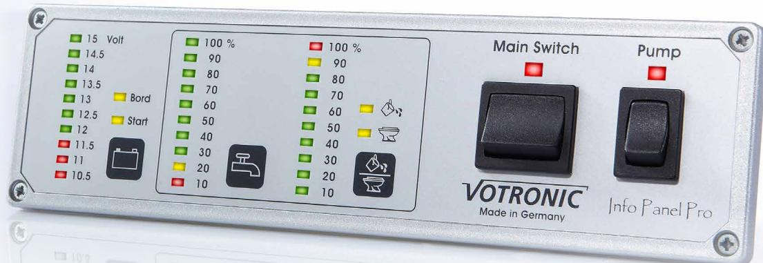
Bord- und Starter-Batterie werden per Spannungsanzeige kontrolliert. Die Leuchtbalken ermöglicht dabei eine sehr genaue Darstellung der Batteriespannung, weil auch Zwischenwerte durch unterschiedliche Leuchtkraft benachbarter LED's hervorragend ablesbar sind. Auf Tastendruck wird entweder die Bord- oder Starter-Batterie dauerhaft angezeigt oder die Anzeige abgeschaltet. Im ausgeschalteten Zustand sind das VOTRONIC Info Panel Pro und die angeschlossenen Tankgeber komplett stromlos.
