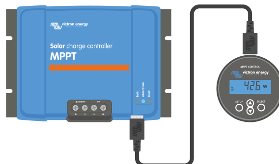
Verbinden Sie das Display mithilfe eines VE.Direct-Kabels mit dem Solarladegerät.
